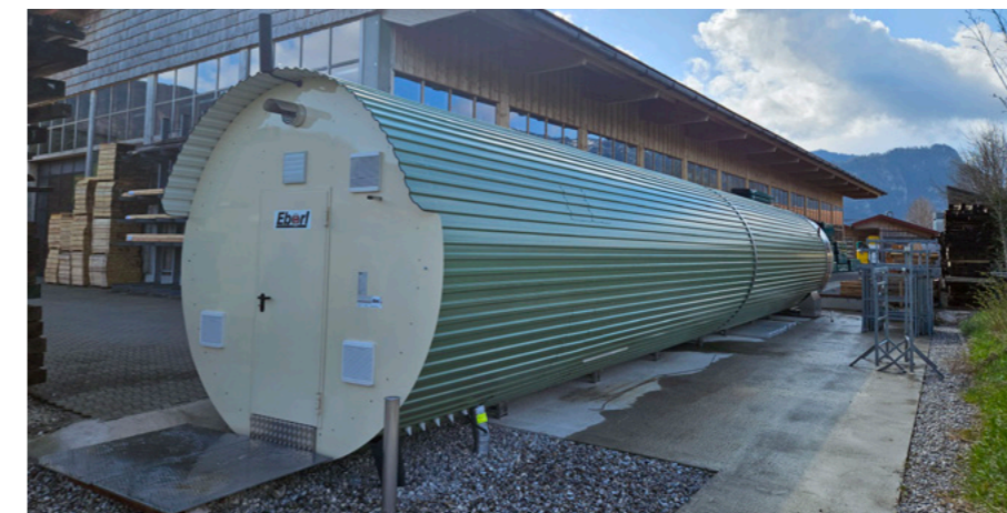
Mit dem Dämpftrockner ist es Eberl gelungen die beiden Prozesse Dämpfen und Trocknen zu vereinen. Was sonst mehrere Wochen dauert, schafft die Anlage in sieben bis zehn Tagen
