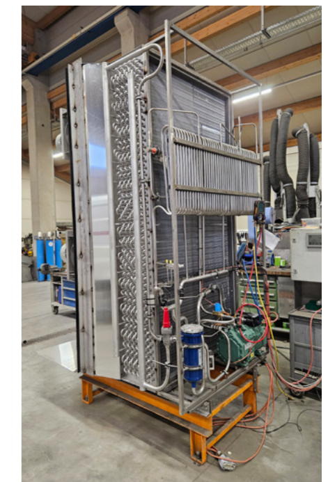
Die Wärmepumpe ist das Herzstück des V-Premium-Energiespartrockners
