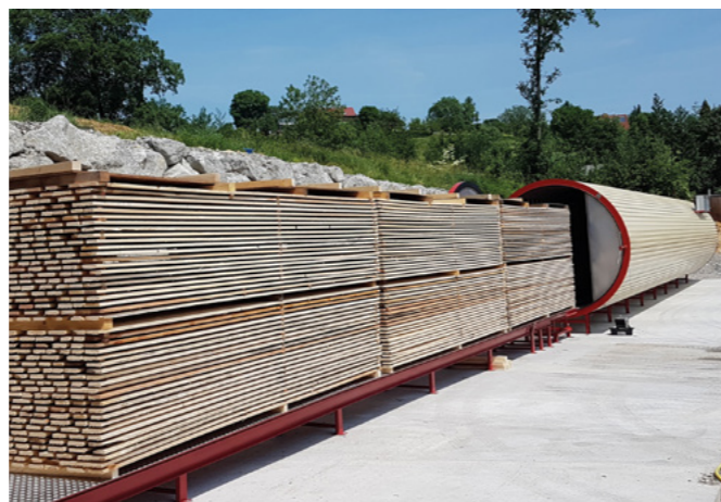
Eberl-Vakuorkammern sind mit einem Stapelrauminhalt von 1,5 bis 100 m 3 erhältlich und damit für zahlreiche Anwendungsfälle interessant
