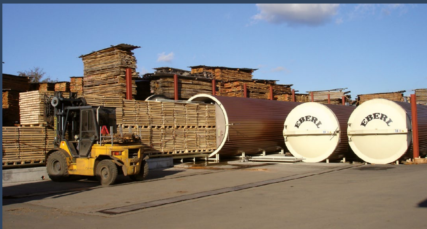
Przygotowanie wsadu do suszarni V-Premium
