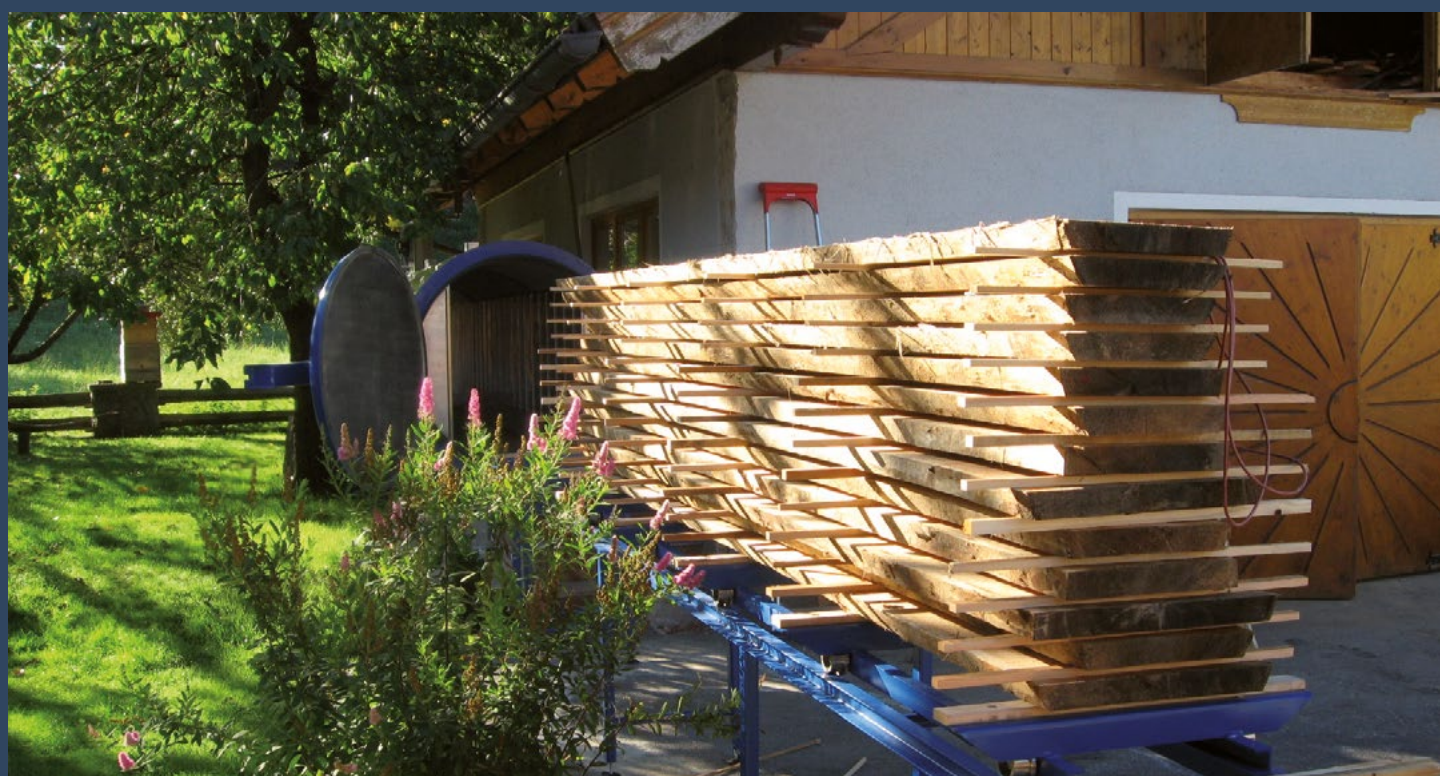
Chargement avant introduction dans le V-Basic
